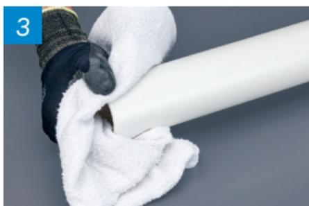
*La humedad retrasará el curado y la suciedad, el aceite o cualquier material extraño puede impedir una soldadura adecuada.*
