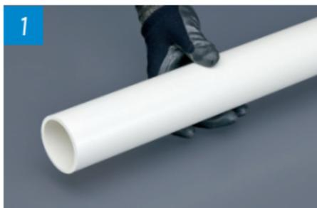
*Los cortadores de tubos de plástico también se pueden usar para cortar tubos de plástico; sin embargo, estos producen un cordón elevado al final de la tubería. Este cordón debe eliminarse con una herramienta de biselado Weld-On.*
